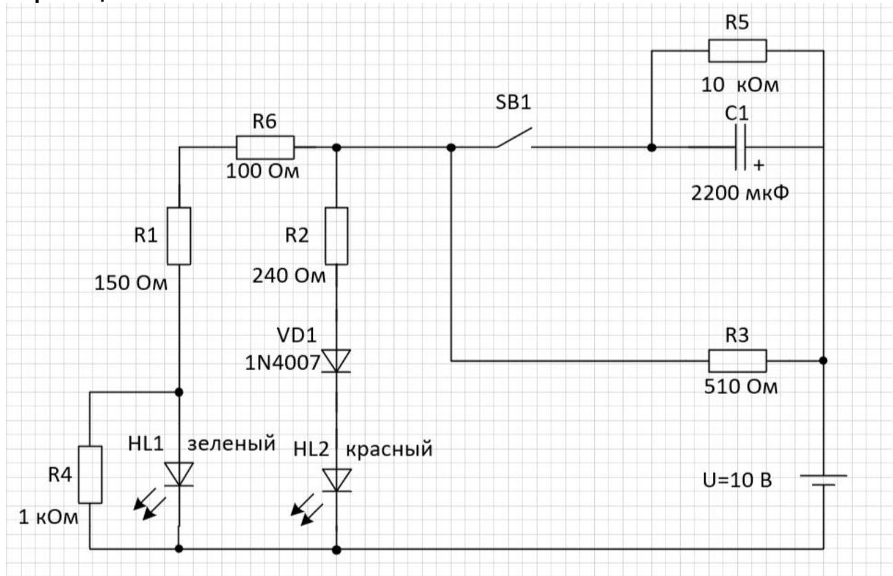
Подключить источник питания в указанной полярности, напряжением 10 вольт.
